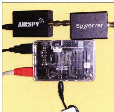
Bild 11: Odroid-C2 mit SDR-Hardware Airspy und passendem KW-Konverter
