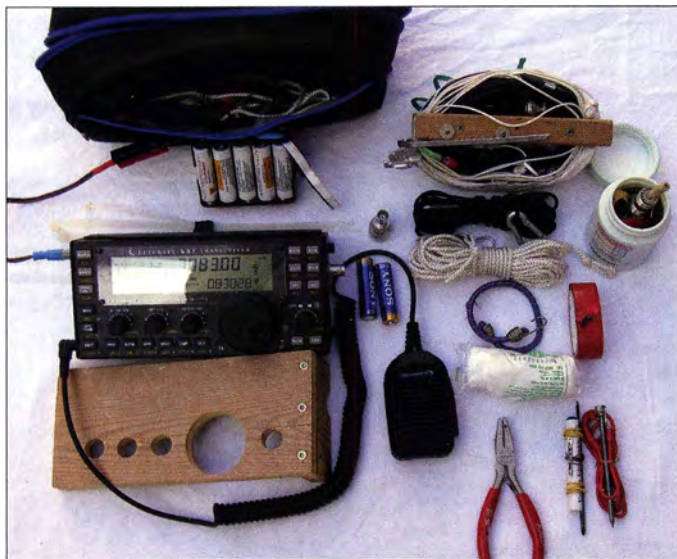
Bild 1: In die etwa 25 cm lange Transporttasche (Waschbeutel) oben links passt eine komplette, für die Aktivierung von Bergen auf 20 m bis 10 m geeignete QRP-Station samt Zubehör. Lediglich ein 7-m-Teleskopmast ist separat mitzuführen.
