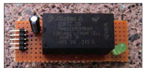
Bild 2: Steckbar ausgeführter RTC-Baustein mit I 2 C-Schnittstelle, hier der M41T00CAP
