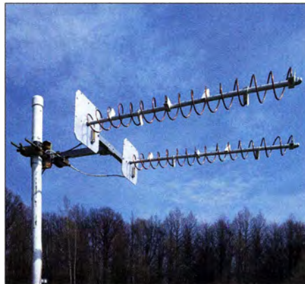
Bild 17: Helixantennengruppe 2 × 50 cm, 15,5 Windungen, horizontal gestockt
