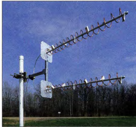
Bild 16: Helixantennengruppe 2 × 50 cm, 15,5 Windungen, vertikal gestockt
