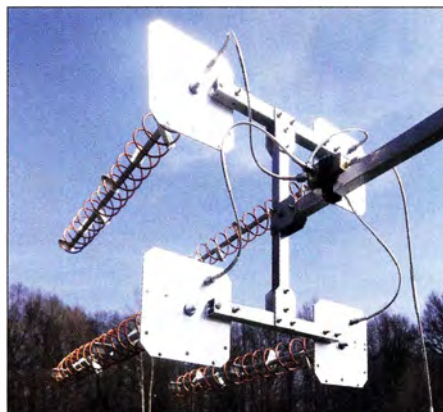
Bild 18: Helixantennengruppe 4 × 50 cm, 15,5 Windungen, quadruple
