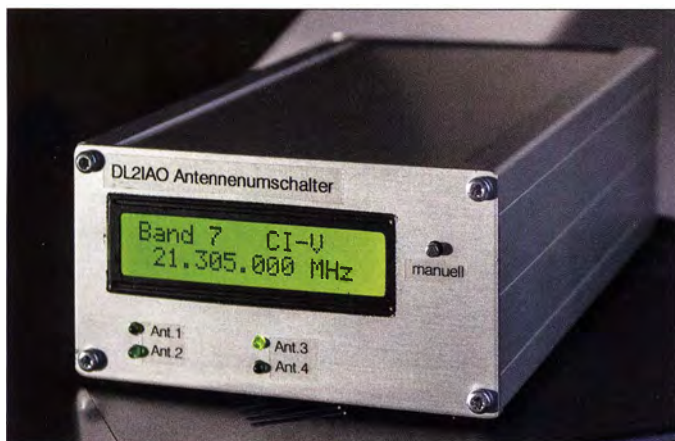
Bild 1: Frontseite des automatischen Antennenumschalters für Icom-Transceiver; die vier LEDs unterhalb des Displays zeigen an, welche Antenne gerade zugeschaltet ist.
