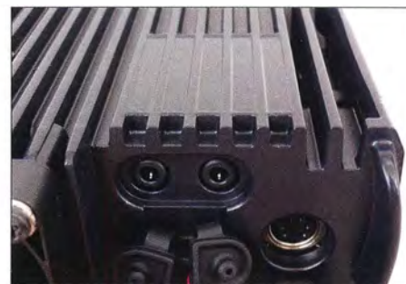
Bild 6: Unter Abdeckungen finden sich Lautsprecheranschlüsse und eine Mini-DIN-Buchse für Fernsteuerung und Packet-Radio.
