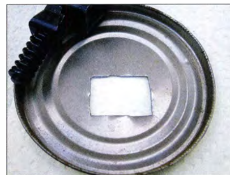
Bild 6: Mit etwas Übung lassen sich auch längere gerade Kanten mit dem Blechnibbler herstellen. Fotos: DF7BL
