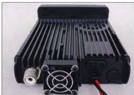
Bild 5: Der Blick auf die Rückseite offenbart neben dem Lüfter die gemeinsame Antennenbuchse (SO239) für 2 m und 70 cm.
