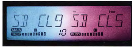
Bild 12: Betriebszuständen und Bändern lassen sich unterschiedliche Farben zuweisen.
