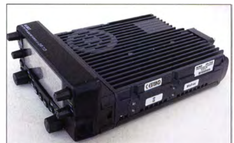
Bild 3: Ein Lüfter unterstützt die großen Kühlrippen.
