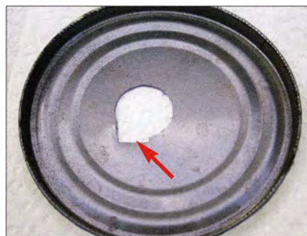
Bild 4: Mit der Schneide des Blechnibblers lässt sich die Bohrung auf das gewünschte Maß vergrößern – hier der erste Schnitt.
