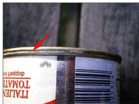
Bild 3: Der beim Aufschneiden einer für die Weiterverwendung als Gehäuse geeigneten Dose entstehende Schnitt muss glatt sein.
