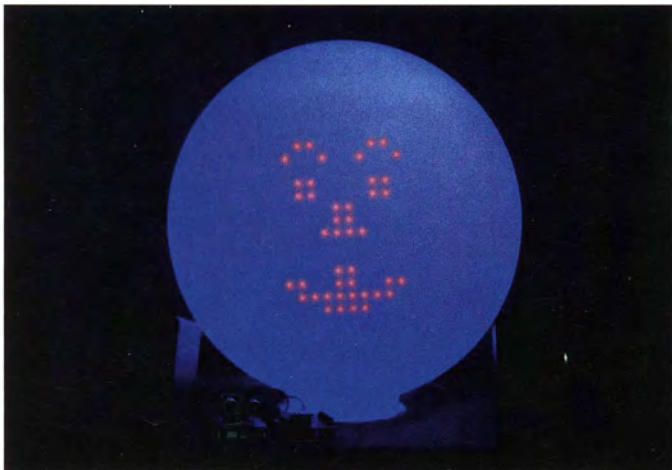
Bild 1: Das Gesicht unseres Roboters ist in eine für Lampen vorgesehene Kugel eingebaut, an die es von innen projiziert wird. Zusätzlich wurde zur diffusen Beleuchtung eine blaue, nach hinten strahlende LED in die Kugel gesetzt.
