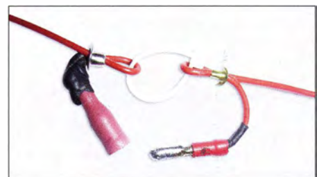
Bild 2: Geöffnete Trennstelle in der Multi-Monobandantenne Fotos: OE7HPI
