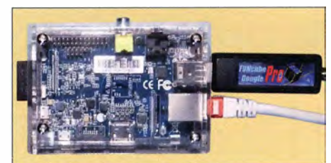
Bild 2: Der Banana Pi mit angeschlossenem Fungcube Dongle Pro+ ist eine typische Testkonfiguration für einen SDR-Monitorempfänger.
