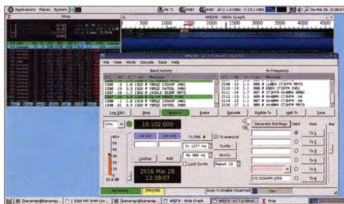
Bild 8: Empfang im 17-m-Band mit WSJT-X auf dem Banana Pi mit angeschlossenerm RTL-SDR-Stick (TCXO)
