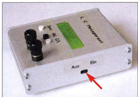
Bild 2: Das Modul ist so im Gehäuse zu befestigen, dass der Betätigungshebel des Schalters seitlich herausragt. Fotos: DJ7JW
