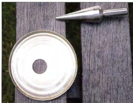
Bild 2: Selbst für einen rechteckigen Durchbruch ist zuerst mit dem Schälbohrer ein rundes Loch herzustellen.
