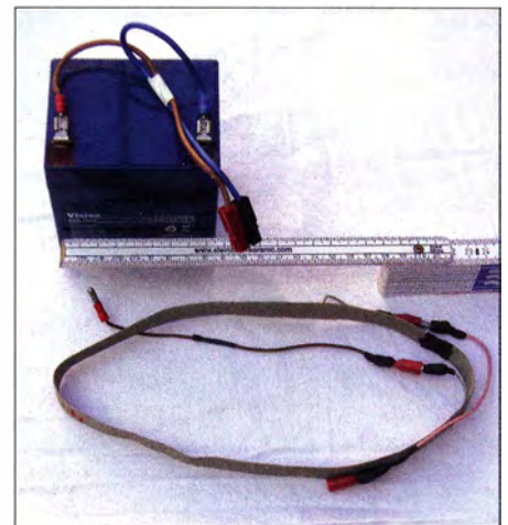
Bild 3: Die zusätzliche Mitnahme eines LiFePO 4 -Akkumulators und einer aus achtadrigem Flachbandkabel hergestellten Verlängerungsspule ermöglicht den Betrieb auf 40 m und mit 10 W.
