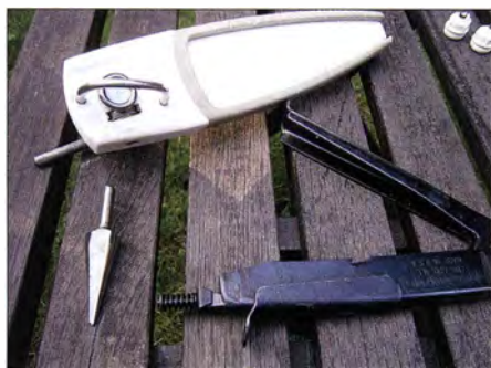
Bild 1: Werkzeuge zur Bearbeitung von Gehäusen aus Weißblech; Dosenöffner (oben), Schälbohrer (links) und Blechnibbler (rechts)
