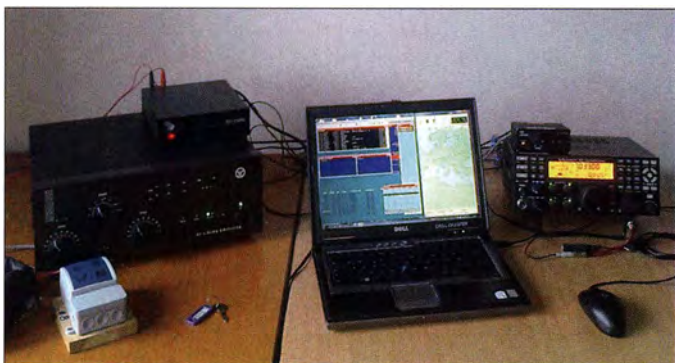
Im Shack von Z60WW: Transceiver Elecraft K3, Antennenumschalter, Endstufe ACOM1010 und Notebook
